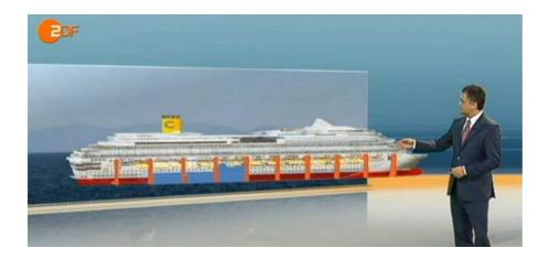
... Insgesamt gibt es 12 Decks. Sie sind durch Trennwände, sogenannte Schotten unterteilt. So entstehen einzelne wasserdichte Bereiche, die im Havarie-Fall volllaufen, die aber dafür sorgen, dass sich das Wasser nicht ausbreiten kann. <u>Das größte Leck der Concordia ist 70 Meter lang</u> (das stimmt <u>nicht</u>, da es <u>kein</u> durchgehendes Leck von 70 Meter ist [s.o.]).
